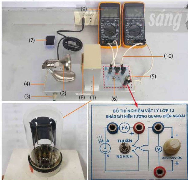
▲ Hình 7.2. Bộ dụng cụ khảo sát hiệu ứng quang điện
