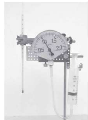
c) Bộ thí nghiệm khảo sát các định luật chất khí sử dụng bơm tiêm y tế – thí nghiệm cải tiến
