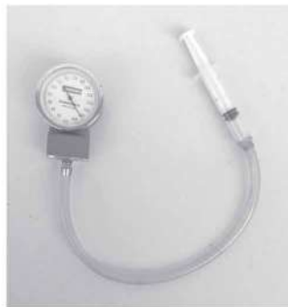
b) Bộ thí nghiệm khảo sát định luật Boyle, định luật Charles sử dụng thiết bị đo huyết áp – thí nghiệm tự tạo
