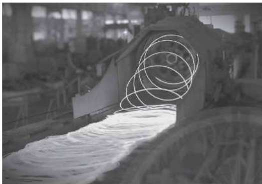
▲ Hình 1.8. Thép được đưa ra khỏi khuôn và để nguội trong nhà máy luyện thép
