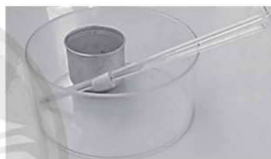
▲ Bộ dụng cụ thí nghiệm xác định chiều truyền năng lượng nhiệt giữa hai vật
