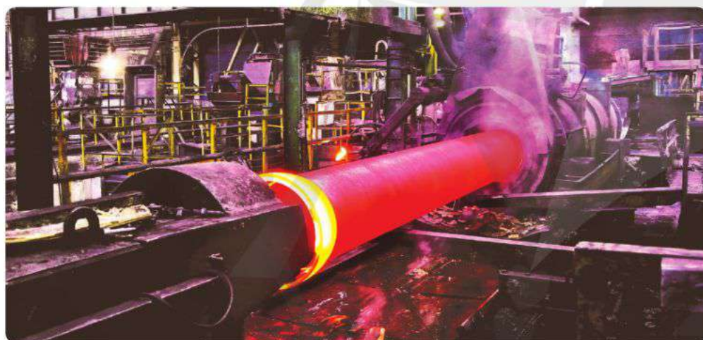
Hình 17.7. Thép được đúc thành ống trong quá trình làm nguội
