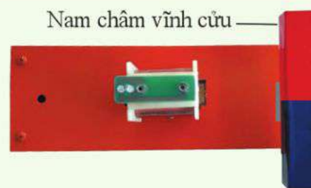
Hình 11.7. Thí nghiệm cảm ứng điện từ với nam châm quay
