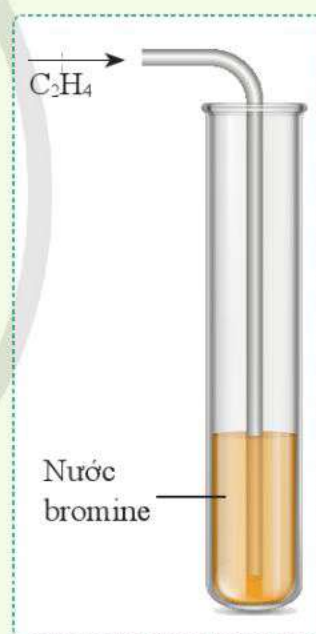
Hình 21.2. Thí nghiệm ethylene tác dụng với nước bromine
