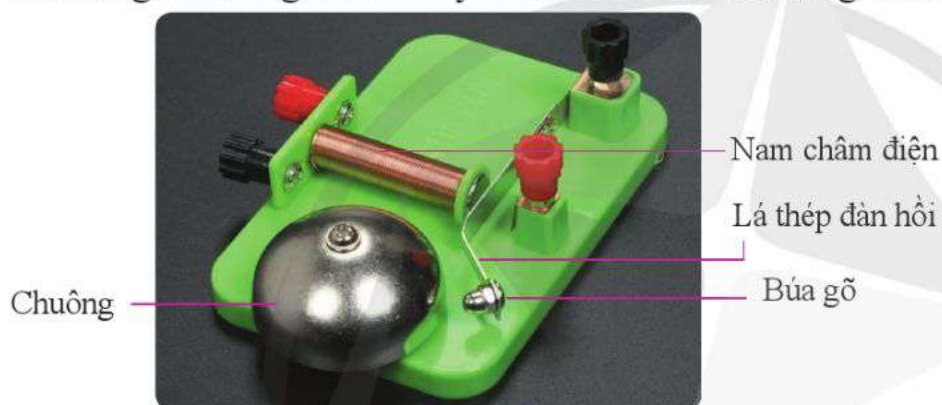
Hình 12.3. Cấu tạo của chuông điện
