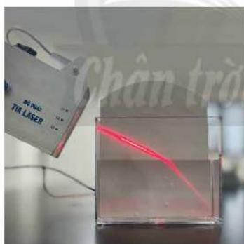
▲ Hình 4.1. Thí nghiệm tìm hiểu hiện tượng khúc xạ ánh sáng
