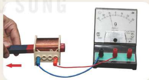
b) Đưa cực Bắc của thanh nam châm vĩnh cửu ra xa cuộn dây dẫn
