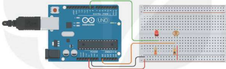
Hình 26.2. Mạch điện tự động điều chỉnh cường độ sáng của LED theo điều kiện chiếu sáng xung quanh
