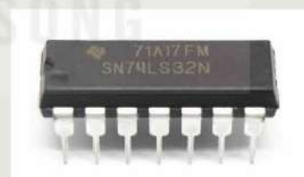
Hình 16.6. IC 74LS32 và sơ đồ chân tương ứng
