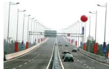
Hình 7.31. Các cây cột đèn có phương thẳng đứng nên không vuông góc với mặt dốc. (Ảnh: congan.hochiminhcity.gov.vn )
