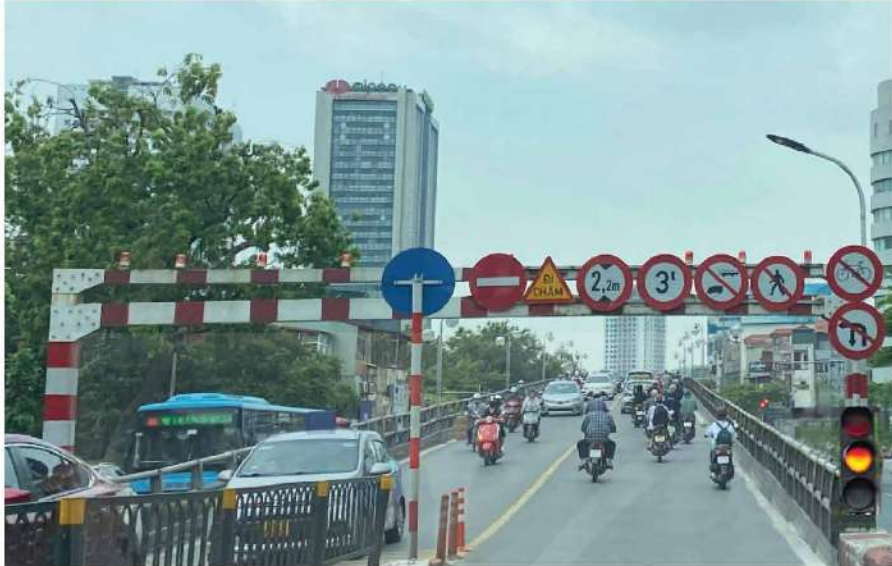
Hình 7.82. Tại đầu một số cầu vượt ta có thể bắt gặp khung không chế chiều cao.
