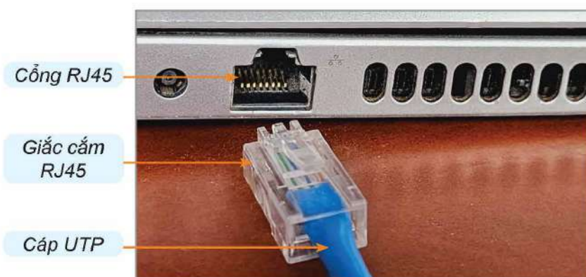
Hình 3.8. Giắc cắm và cổng RJ45
