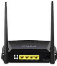
a) Modem ADSL; cổng bên trái dùng cho cáp ADSL với đầu cáp kiểu cáp điện thoại
