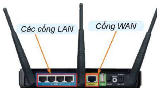
Hình 22.4. Một router Wi-Fi 3 anten có 4 cổng LAN và 1 cổng WAN
