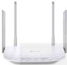
Hình 22.6. Một bộ thu phát Wi-Fi băng tần kép, 4 anten, hỗ trợ tối đa 25 người
