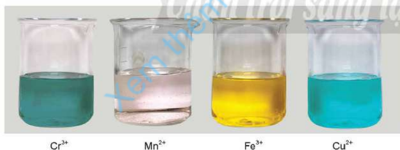
▲ Hình 19.1. Màu sắc trong dung dịch của một số ion kim loại chuyển tiếp dây thứ nhất
