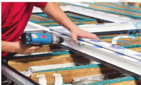
Hình 13.8. Nhờ tính dẻo và có độ cứng vừa phải nên nhôm dễ gia công (a) và tạo hình (b)
