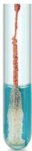
Hình 10.2. Hiện tượng xảy ra khi cho kim loại Cu vào dung dịch AgNO 3
