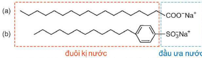
Hình 2.2. Công thức cấu tạo của một số chất hoạt động bề mặt: xà phòng (a) và chất giặt rửa phổ biến (b)
