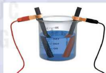
Hình 20.2. Điện phân dung dịch \text{CuSO}_4 với hai điện cực than chì
