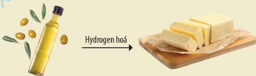
Hình 1.3. Hydrogen hoá dầu thực vật thành bơ thực vật
