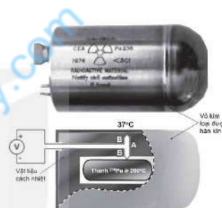
Hình 23.19. Pin nguyên tử sử dụng đồng vị ^{236}\text{Pu}
