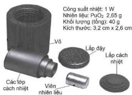
Hình 23.21. Nguồn nhiệt công suất 1 W nhờ phóng xạ
