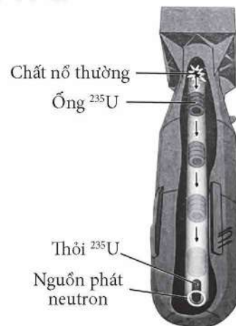
Hình 24.7. Nguyên lý thiết bị nổ hạt nhân phân hạch không môi nổ
