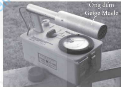
Hình 23.8. Máy đo phóng xạ có gắn ống đếm Geige Muele
