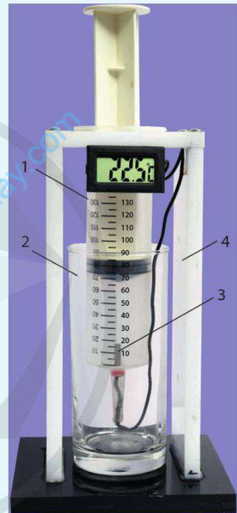
Hình 2.3. Thí nghiệm về sự thay đổi nội năng bằng truyền nhiệt
