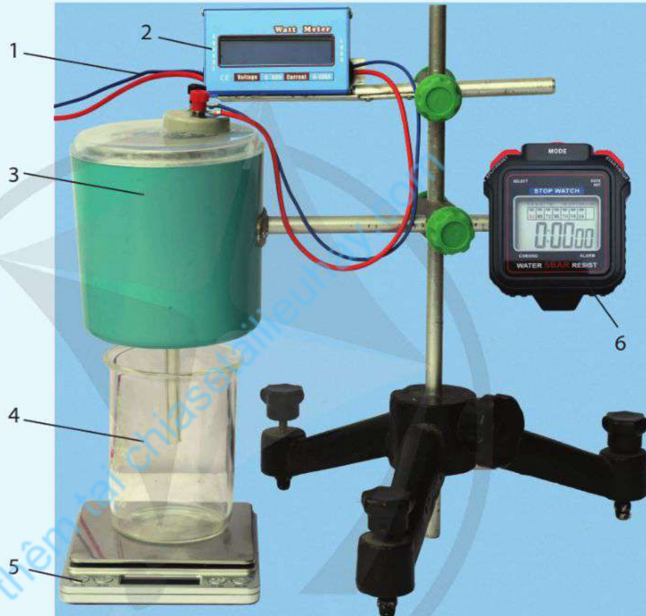
Hình 4.5. Thí nghiệm xác định nhiệt nóng chảy riêng của nước
