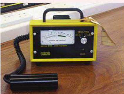
Hình 3.8. Máy dò bức xạ hạt nhân Geiger
