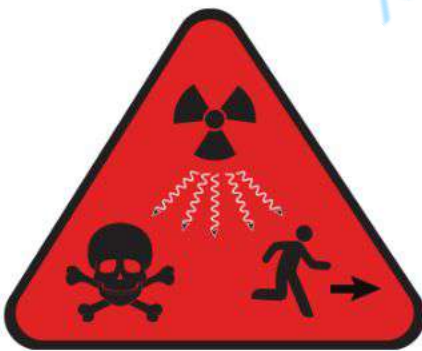
b) Biển báo nguy hiểm do phóng xạ với những nguồn có mức độ nguy hiểm cao như nguồn phóng xạ trong điều trị bệnh hay chiếu xạ công nghiệp
