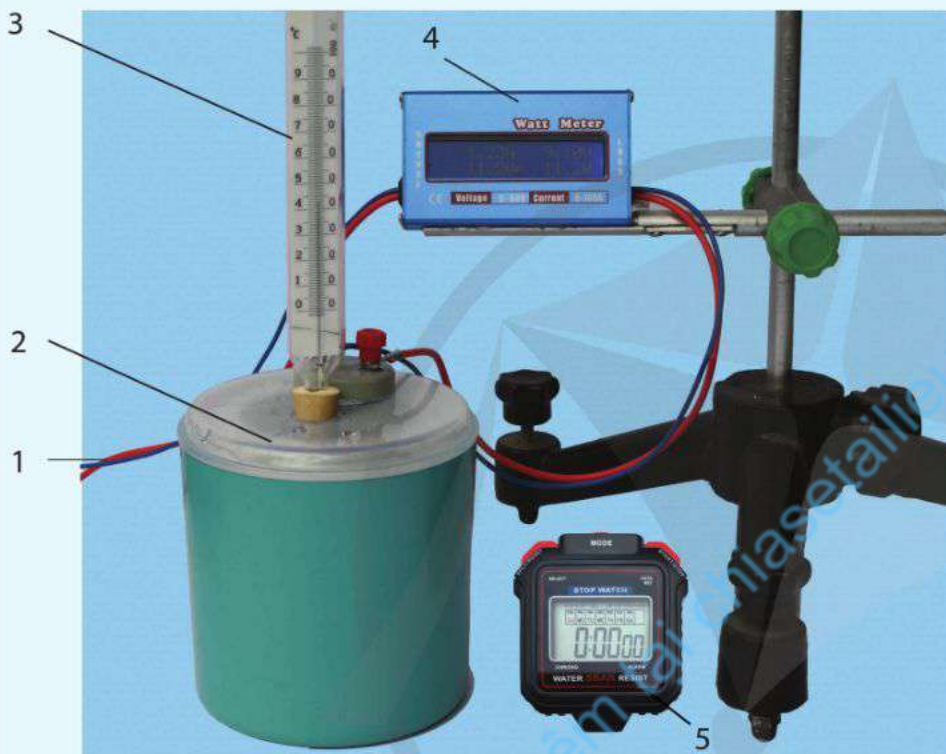
Hình 4.3. Thí nghiệm xác định nhiệt dung riêng của nước
