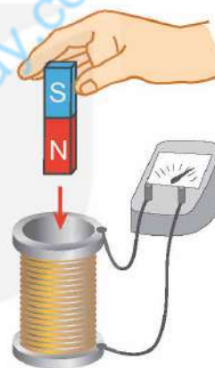
Hình 19.1. Thí nghiệm xuất hiện điện trường xoáy khi nam châm rơi qua ống dây
