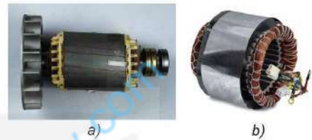
Hình 17.5. Rôto (a) và stator (b) của máy phát điện xoay chiều
